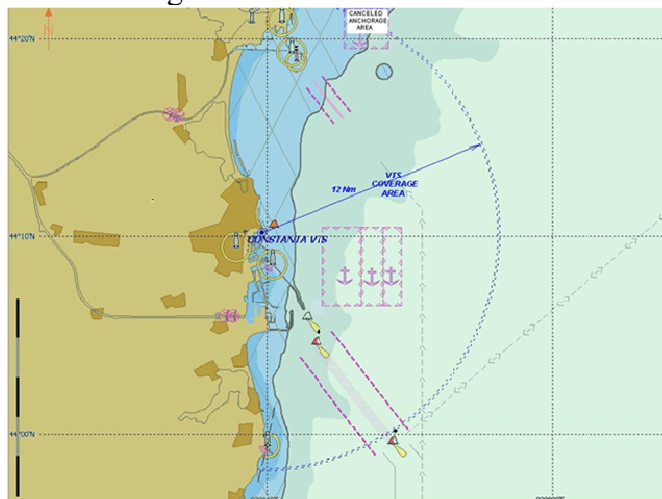
Fig. 103 Aria de acoperire a sistemului VTMISS Constanța
