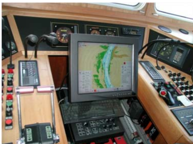
Fig. 74 Aspectul sistemului AIS și Inland ECDIS la bordul unei nave, cu suport pentru VTT
